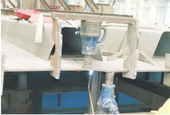
图2 钢板平面的角变形-校正图
