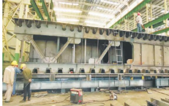
图3 钢箱梁角变形检查工序图
