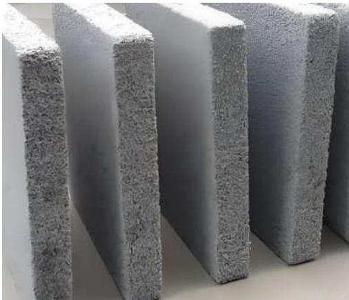
图2 泡沫混凝土
