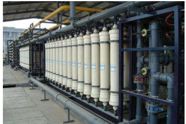
图1 膜处理废水工艺
