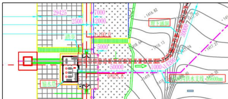
图3 输水塔与输水涵管关系图
