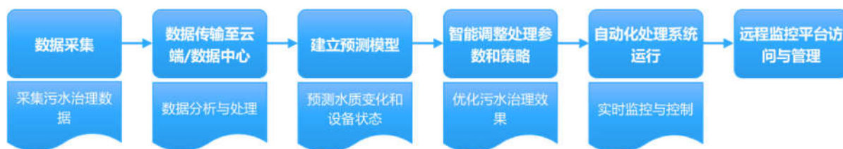
图1 污水处理智能监控与管理流程图
