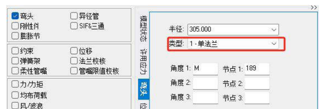
图4 在案例2中，1#和2#弯头的“类型”设置
