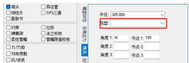
图3 在案例1中，1#和2#弯头的“类型”设置
