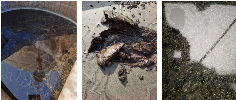
图1-2 脱硫液表面夹带少量油状物
