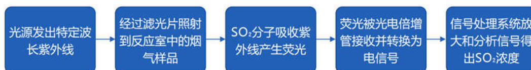
图1 紫外荧光法工作流程
