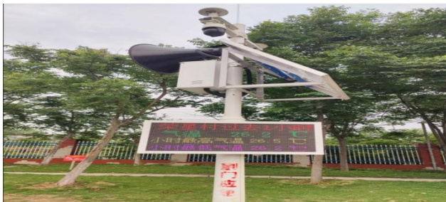
图2 地质灾害气象风险预警系统显示屏装置实物图
