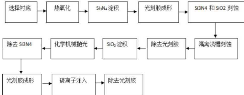
芯片制造工艺流程图
