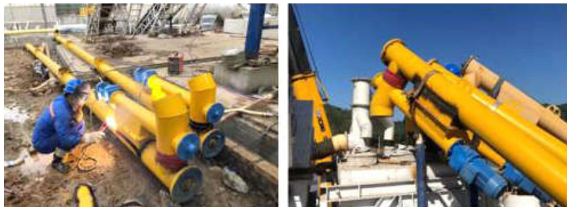
图3和图4改造后的普通螺旋输送机改制可以粗、精计量的子母螺旋
