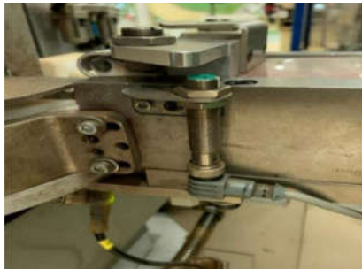
图4 烟包轧包后顶开上挡板导致停机示意图
