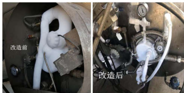
图5 改造前后LNG气瓶阀件附近结冰情况
