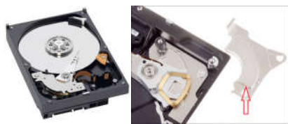
图1 硬盘音圈电机及磁钢片
