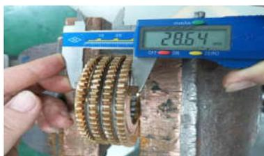
图7 新的七个阻尼片的尺寸图
