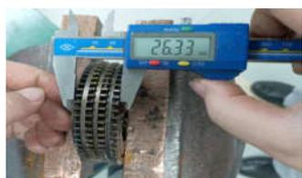
图5 使用后七个阻尼片叠加尺寸图
