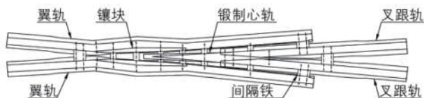
图1 镶嵌翼轨式合金钢组合辙叉
