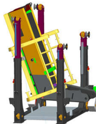
图4 集装箱正面吊运起重机车架焊接变位专机垂直变位示意
