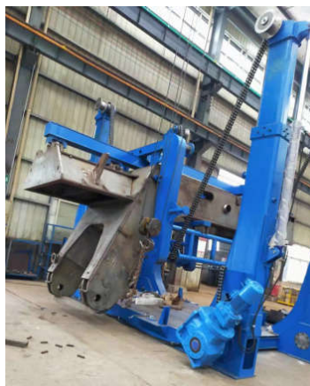
图3 集装箱正面吊运起重机车架焊接变位专机实际应用现场示意
