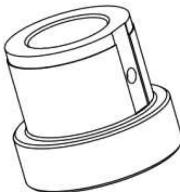
图4 检具测量双基准键槽对称度
