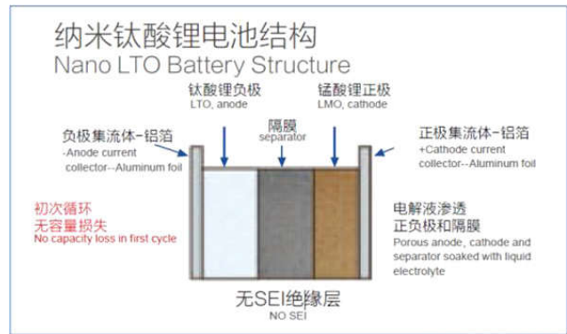
图1 钛酸锂电池结构图
