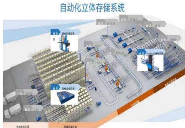
图1 四向穿梭车立体库平面布置示意图
