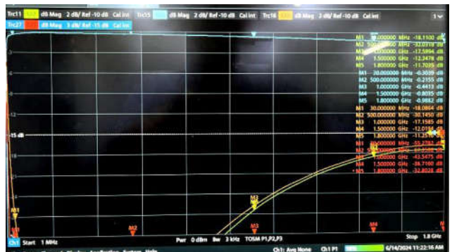
图5 偏置器s参数测试结果
