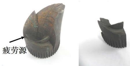
图1 典型案例断面宏观照片
