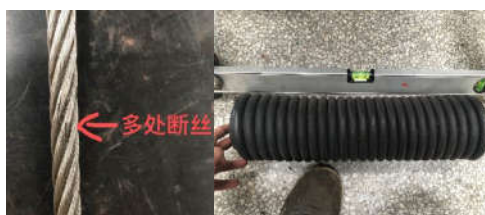
图3 钢丝绳断丝、钢弹簧弯曲变形
