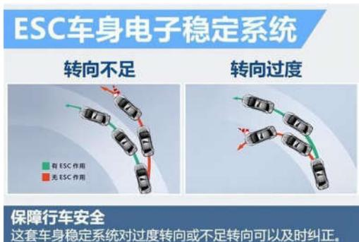
电子稳定控制系统 (ESC) 如图所示
