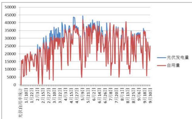
本图为2020年1月1日至9月30日，该再生水厂光伏发电量和自用量的统计。从图中可以看出，蓝色线为光伏发电量、红色线为光伏自用电量。部分天次存在光伏发电量大于自用量，厂内没有完全消纳，造成光伏余电上网。因
