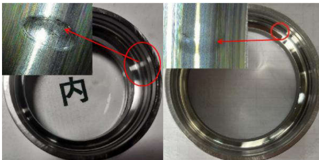
图1 轴承外圈贝壳状剥落
