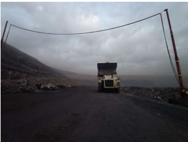
图3 过电缆桥时厢斗举起时的对比图（安装前和安装后）在安全地点拍摄且有专人指挥
