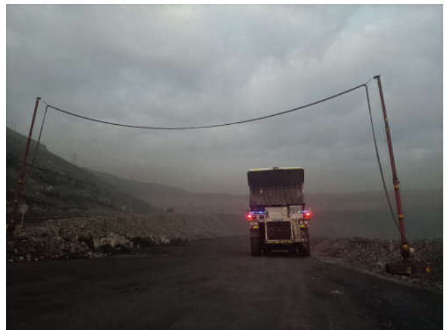
图3 过电缆桥时厢斗举起时的对比图（安装前和安装后）在安全地点拍摄且有专人指挥
