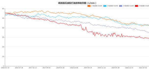
图3 调速器系统3号油泵打油速率趋势图
