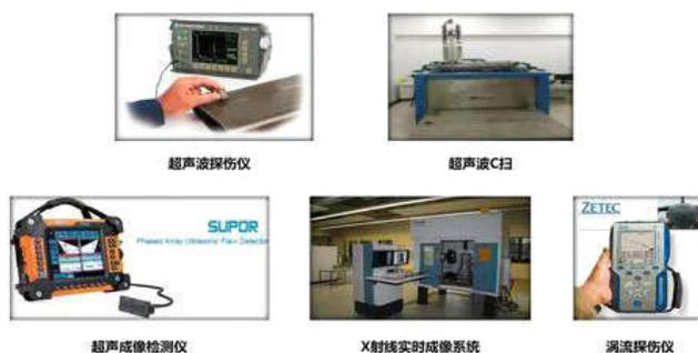
图1 几种常见无损检测技术仪器
