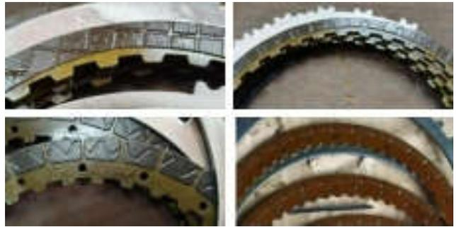
图1 摩擦片结构形式
