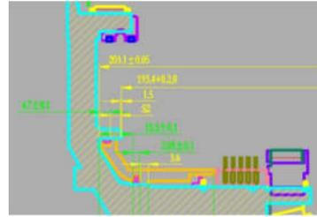
图3 内侧D形环相关尺寸
