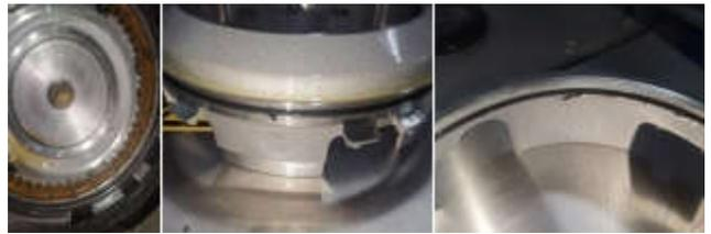
图4 ON-OFF实验后摩擦片和密封环
