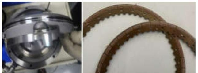
图5 ON-OFF实验后摩擦片和密封环
