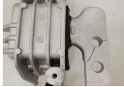
图3 工况模拟试验的断裂件实物
