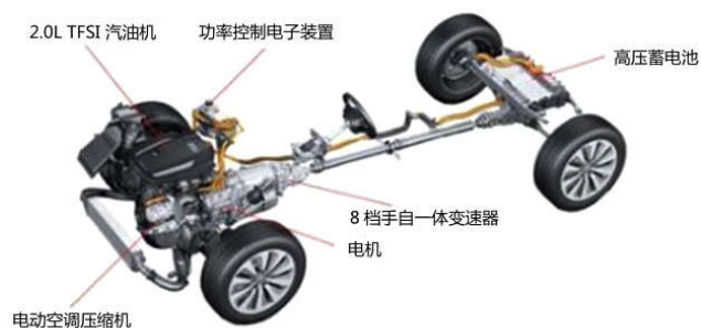
图-3-4 奥迪 Q5 混合动力系统组成
