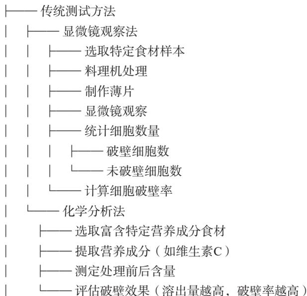
图1 破壁率测试流程图
