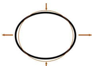
图3 气缸套配合孔变形图
