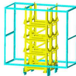
图2 轻量化CNG框架结构图
