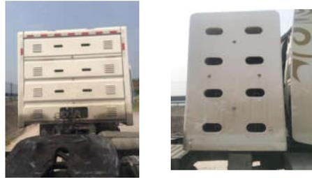
图7 轻量化CNG框架整车试验验证
