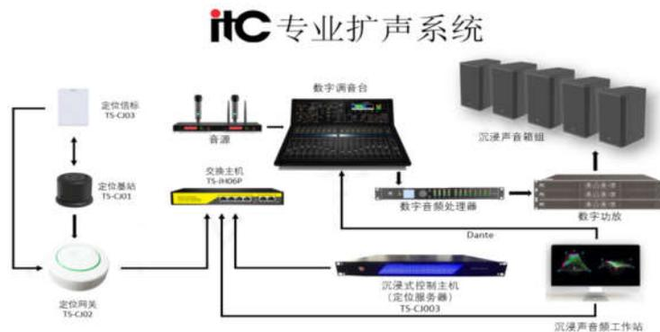
图1 itC扩声系统架构图
