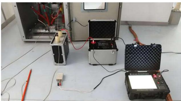
图1 电缆故障测试图
