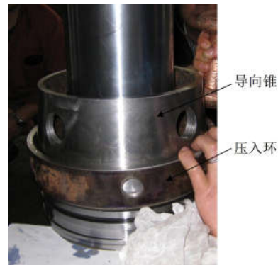
图2 密封加热后利用工装压入
