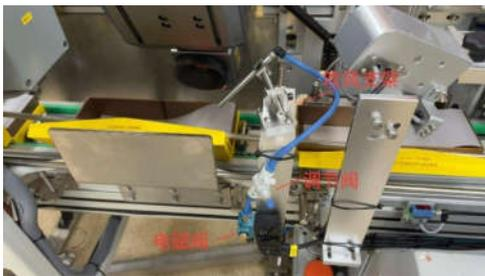
图2 自动控制吹风装置实物图
