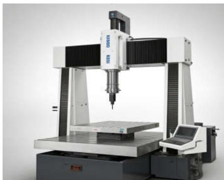
五轴动柱高速铣削机床如图所示
