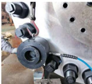
图4 拉伸器连接图
