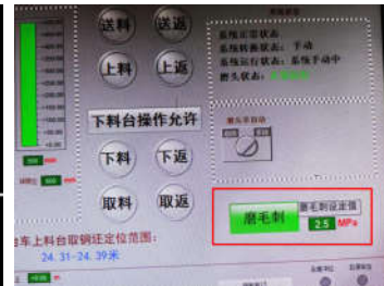
图5 磨毛刺的操作画面
