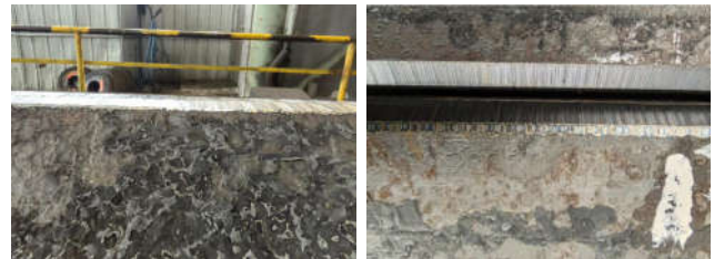
图6 倒角改进前（左）和改进后（右）对比图
