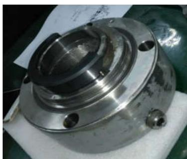
图4 机械密封静环断裂
