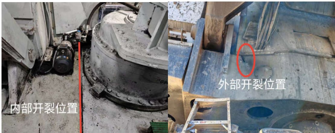
图一电铲回转平台开裂位置图
