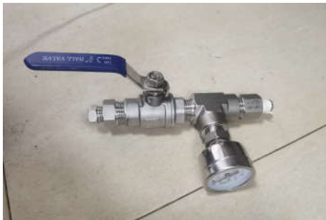
图三 微动测试手动装置
