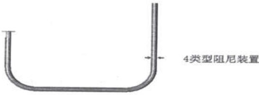
图1: 2、4号管阻尼器安装位置及类型示意图
