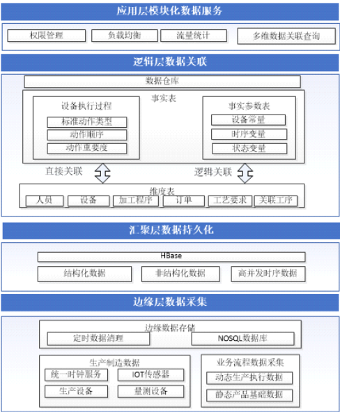
图1 数据采集与关联架构
