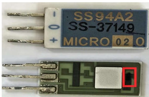
图1 故障P009霍尔传感器内部印刷电路板外貌及过热痕迹
