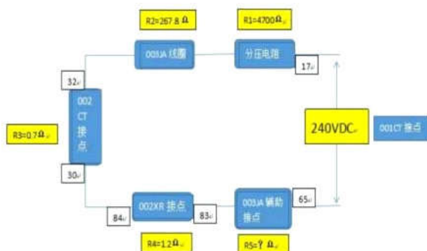
图5 003JA控制回路分压模拟试验图
