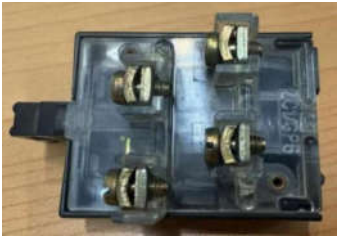
图4 LNE逆变器003JA自保持辅助触点照片
