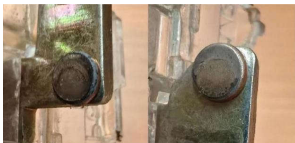
图6 003JA自保持辅助触点静触头表面情况
