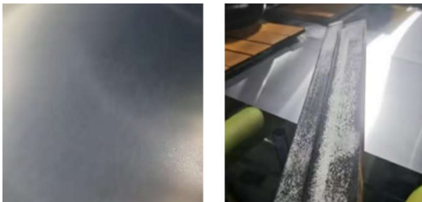
图1 水印缺陷及重度铝粉残留的表面状态图
